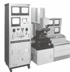
1976年LSIフォトマスク欠陥検査装置 （日刊工業新聞社 十大新製品賞受賞）
